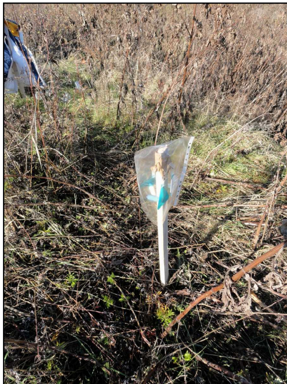
Fig.8. Documentazione fotografica del radiello posizionato al centro della ex-discarica.
