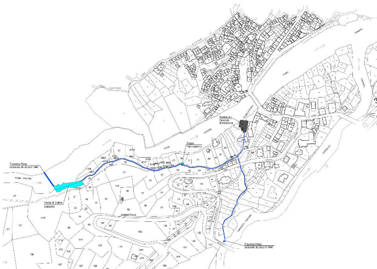
Planimetria Catastrale col posizionamento della presa sul Fiume Sangro (sinistra), della presa sul Torrente Turcano (in basso a destra) e del Locale Centrale (nero). Traversa sul Sangro e sul Turcano e le due condotte interrato
