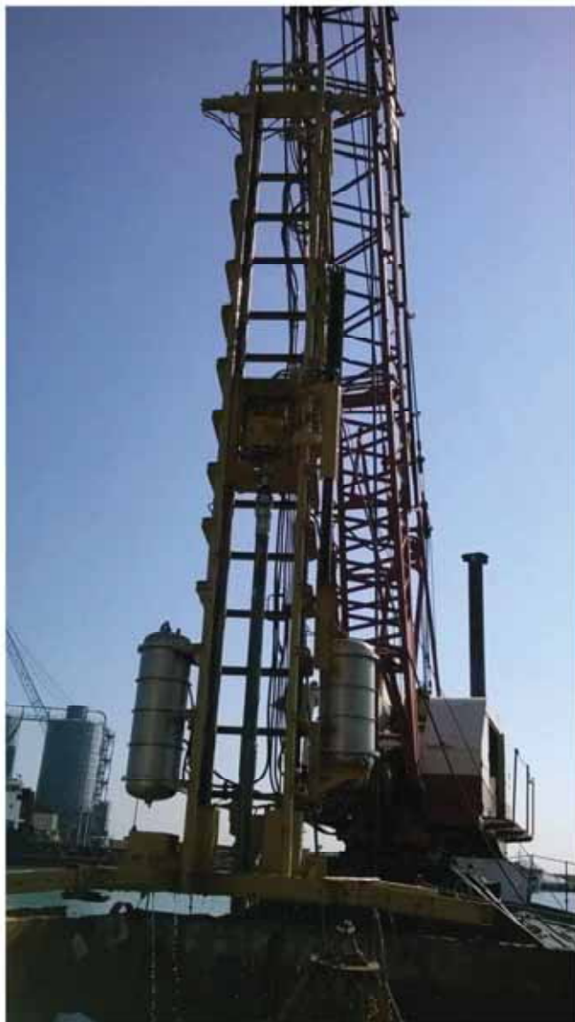
Foto n. 3: Vibrocarotiere utilizzato, della ditta GEOPOLARIS di Livorno, imbarcato a bordo del Motopontone VIGLIENA – PC 1177
