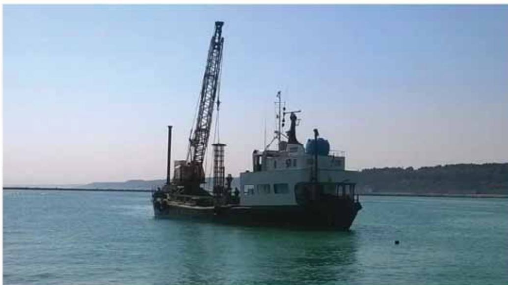
Foto n. 1: Motopontone VIGLIENA – PC 1177 con a bordo il vibrocarotiere, in fase di avvicinamento al punto di prelievo
