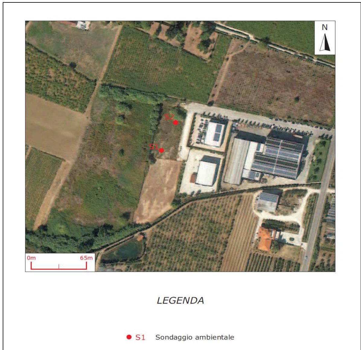
Fig. 3 – Ubicazione dei punti di prelievo dei campioni di terreno all'interno del lotto.
