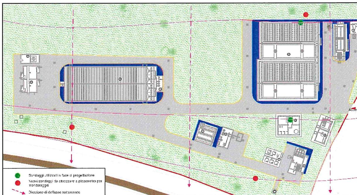
Il tecnico dichiara che saranno effettuati i campionamenti delle acque sotterranee e la misurazione del livello di falda nei piezometri da realizzare e propone un piano di monitoraggio come di seguito riportato, precisando che esso andrà concordato con il Distretto Provinciale dell'Aquila dell'Arta Abruzzo.
