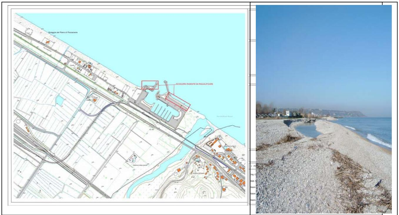
Si procederà alla manutenzione del tratto di barriera radente lunga circa mt. 180,00 mediante la posa di massi naturali di natura calcarea di 2^ Categoria del peso singolo compreso tra 1.000 e 3.000 Kg.
