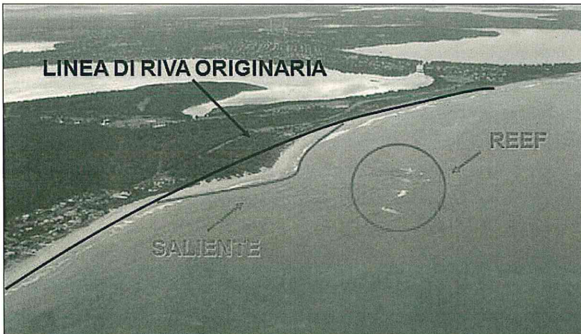
L'effetto, sulla linea di riva, prodotto da una secca artificiale ("reef").
