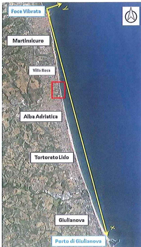
Figura 4.1 - Dominio di calcolo del modello ad una linea di evoluzione del litorale. Il rettangolo in rosso evidenzia qualitativamente l'area di intervento.
