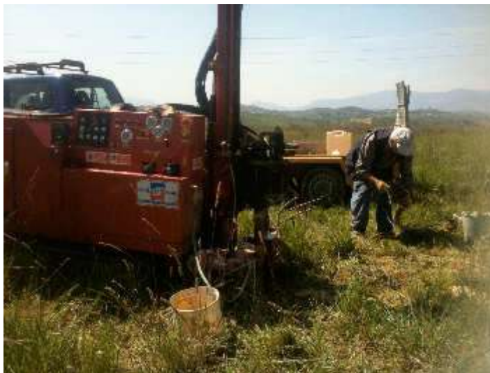
Sono stati anche prelevati campioni indisturbati e rimaneggiati e sulla frazione coesiva sono state eseguite prove rapide di compressione e di resistenza al taglio con il pocket penetrometer.
