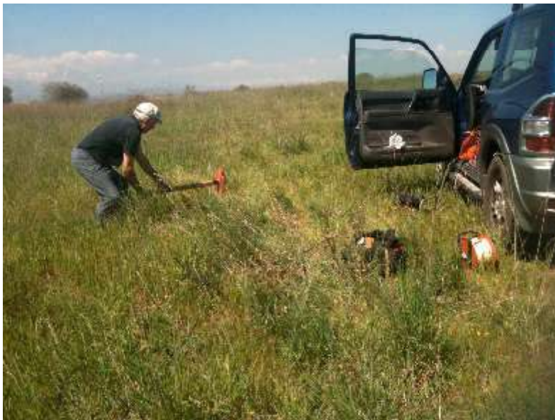
foto 10: esecuzione prospezione sismica
