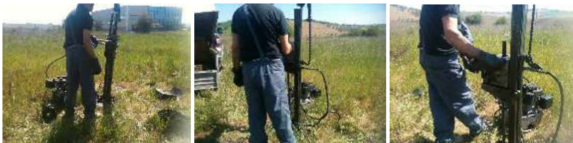
foto 6-7-8: esecuzione prova penetrometrica P1-P2-P3
