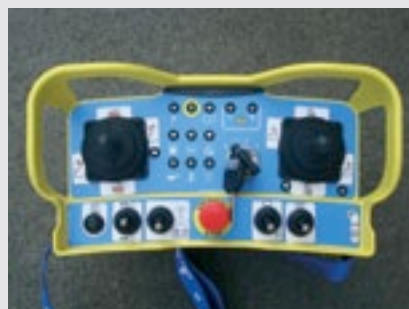
■ Radiocomando a bordo macchina Radiocontrol on board
