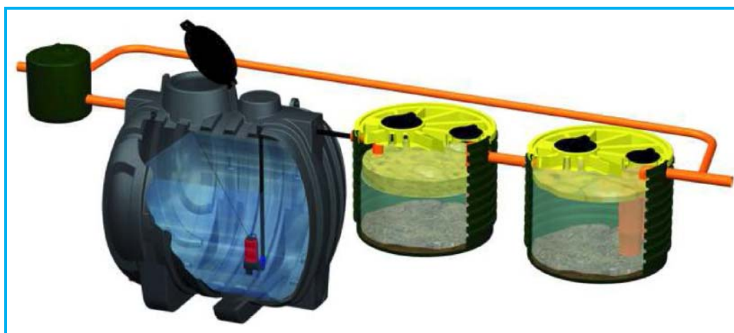
Fig. 15 - IMPIANTO DI TRATTAMENTO ACQUE DI PRIMA PIOGGIA
