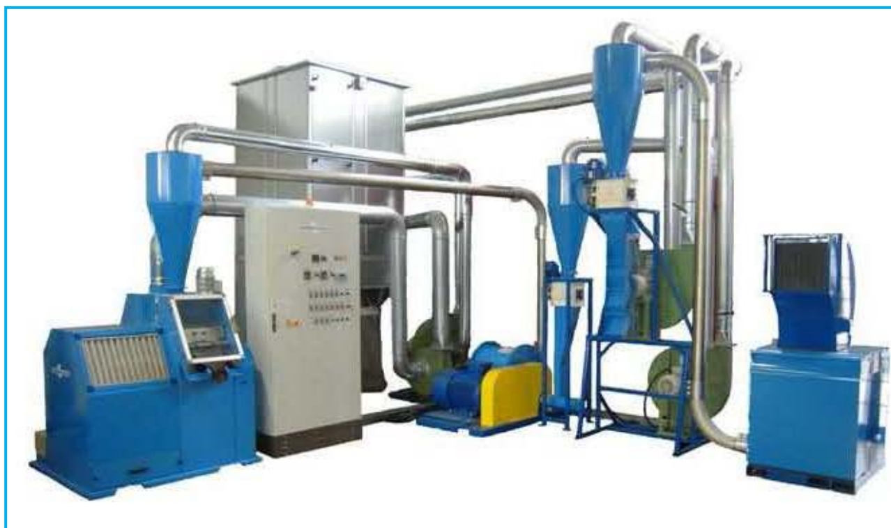
Fig. 15 - IMPIANTO DI TRATTAMENTO DEI CAVI ELETTRICI PER IL RECUPERO DEL RAME/ALLUMINIO
