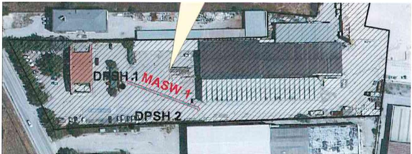
Planimetria con l'ubicazione delle indagini geotecniche e geofisiche
