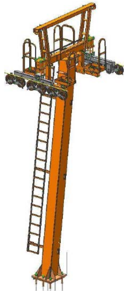
Fig. 20 – Esempio di sostegno in linea.
