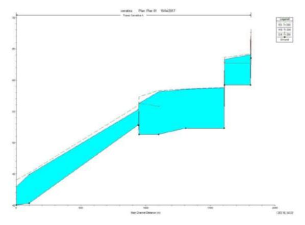
Nella relazione si dichiara che il transito della portata straordinaria genera deflussi regolari senza provocare fenomeni di esondazione e che il tirante idrico generato è compreso tra un minimo di 2,00 m in corrispondenza della sez.3, e un massimo di 7,00 m in corrispondenza della sezione 4, vicino al sito di progetto.
