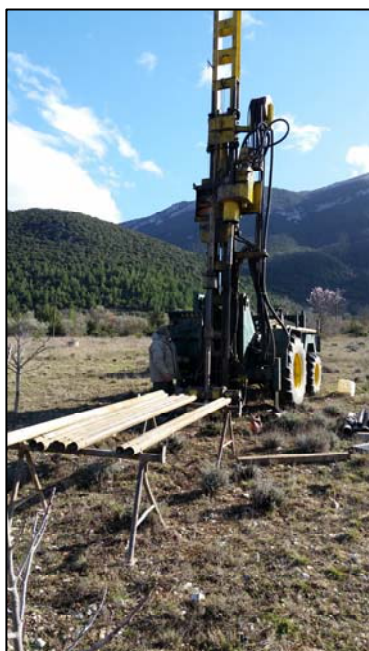
Fig.1 Impianto di perforazione CMV 900.
