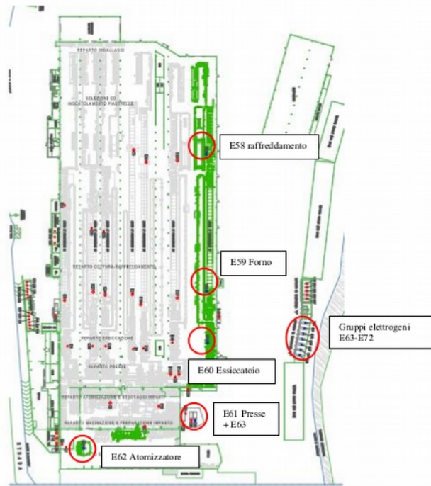
Fig. 4 Layout dello stabilimento con evidenziate a livello grafico la realizzazione del nuovo atomizzatore e della nuova linea di produzione.
