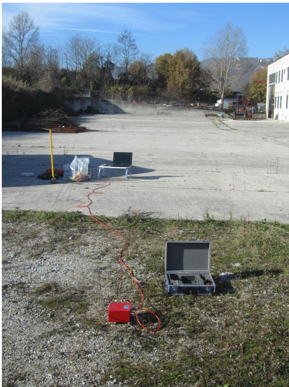
Figura 25: Immagini relative all'ubicazione della prova HVSR ed alla strumentazione GeoBox della Sara electronics instruments
