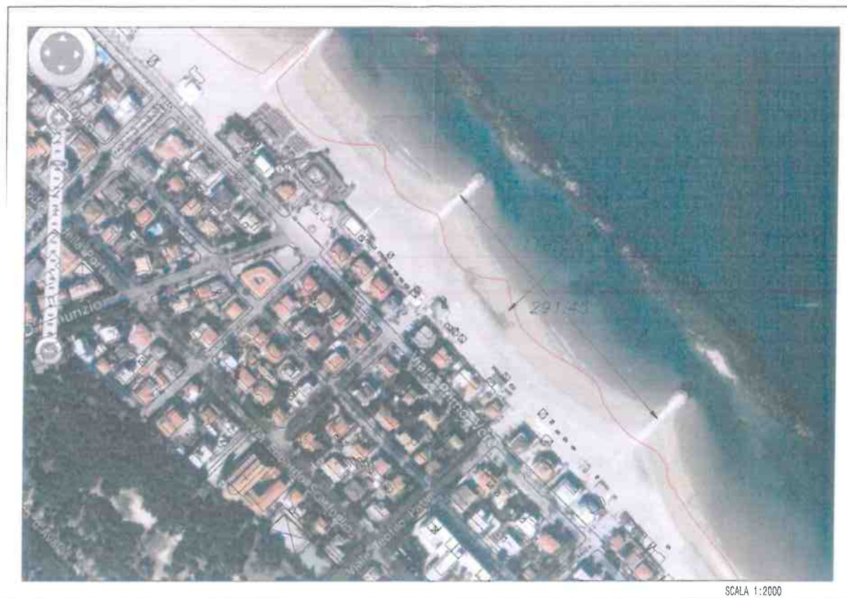
Fig.5 Dimezzamento dell'attuale interasse esistente tra due pennelli (al momento pari a ca. 290 mt) attraverso l'inserimento di un nuovo pennello
