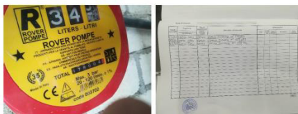
Contatore volumetrico consumo acqua per abbattimento polveri
