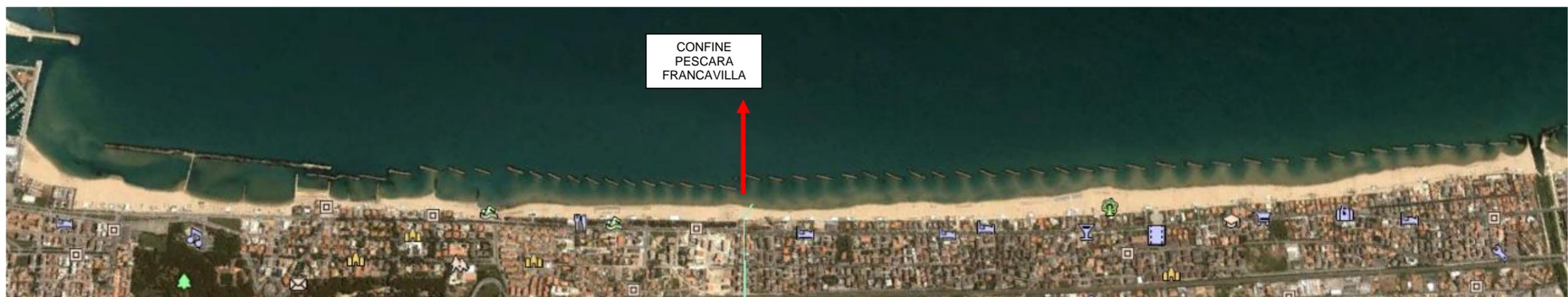
Fig. 6- Anno 2004: Nella parte nord dell'arenile è in corso di realizzazione una longitudinale soffolta.. A tergo di tutto le opere longitudinali è presente una sedimentazione per dinamica diffrattiva più intensa a sud e scema progressivamente verso nord. Il fenomeno è indotto dall'apporto solido dell'Alento.
