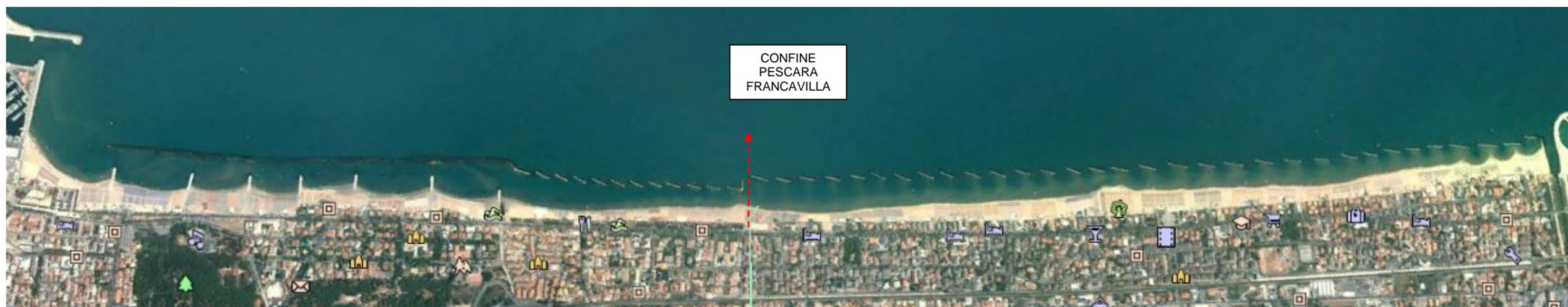
Fig. 7- anno 2008: la scogliera soffolta a nord è stata prolungata verso sud realizzando a tergo 8 pennelli. L'arenile a tergo risulta palesemente stabilizzato. A sud dell'intervento si verifica un arretramento. In corrispondenza del confine comunale e fino all'Alento la linea di riva sembra invece stabile. E' iniziata la costruzione del porto di Francavilla .
