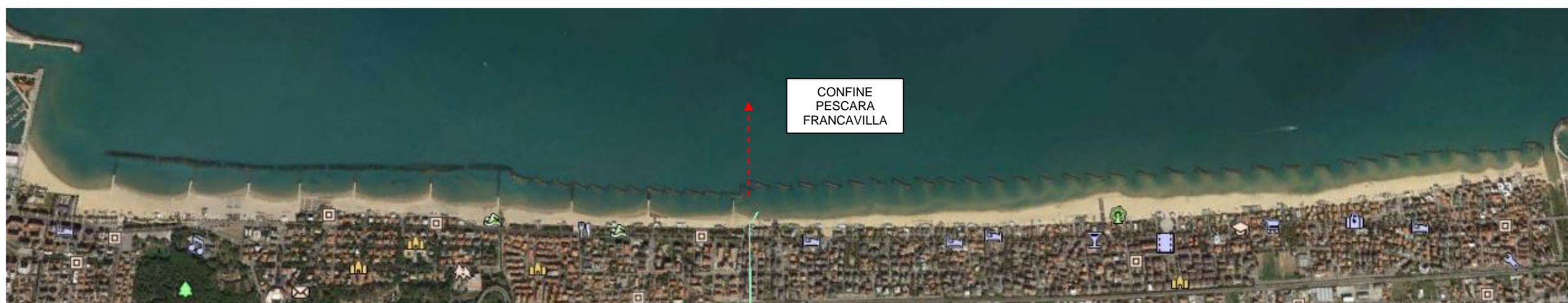
Fig. 8- anno 2013. Nel comune di Pescara tra le difese longitudinali soffolte e il confine con il comune di Francavilla sono state realizzati 3 pennelli. A sud del confine comunale si verifica un palese arretramento della linea di riva.
