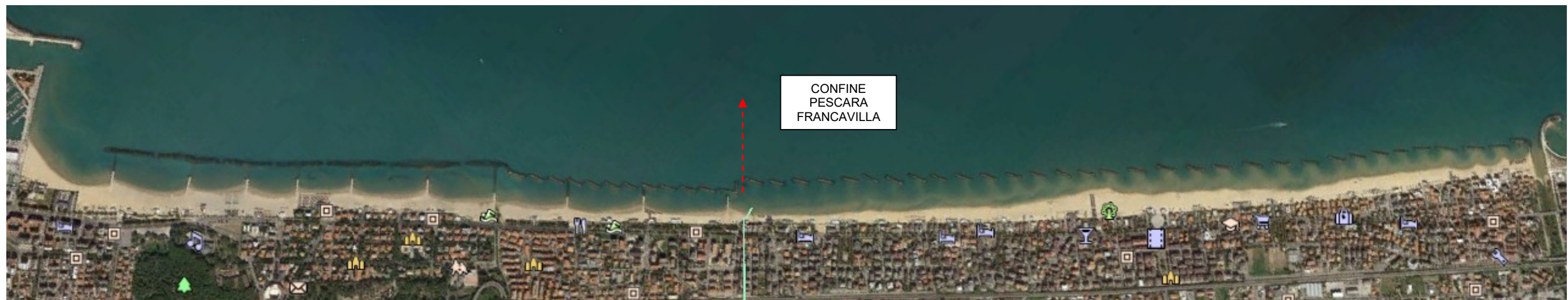
Fig. 5- anno 2013. Nel comune di Pescara tra le difese longitudinali soffolte e il confine con il comune di Francavilla sono state realizzati 3 pennelli. A sud del confine comunale si verifica un palese arretramento della linea di riva.
