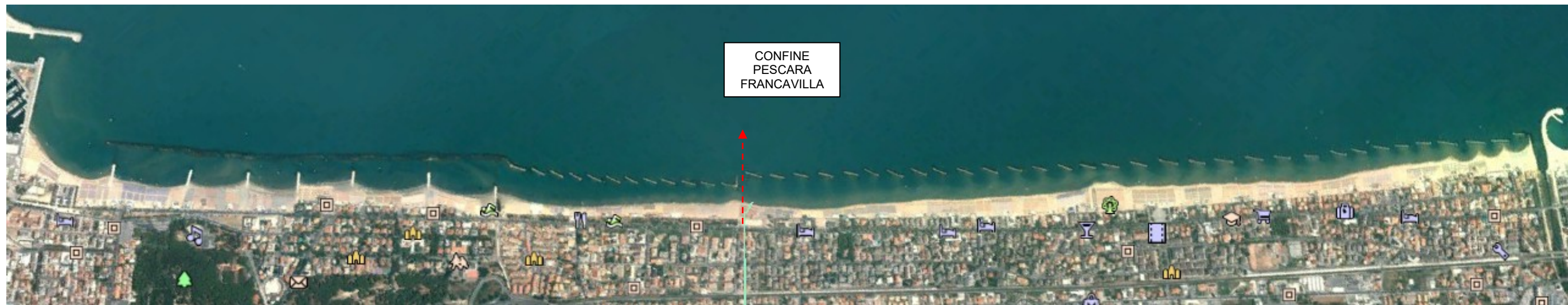
Fig. 4- anno 2008: la scogliera soffolta a nord è stata prolungata verso sud realizzando a tergo 8 pennelli. L'arenile a tergo risulta palesemente stabilizzato. A sud dell'intervento si verifica un arretramento. In corrispondenza del confine comunale e fino all'Alento la linea di riva sembra invece stabile. E' iniziata la costruzione del porto di Francavilla .
