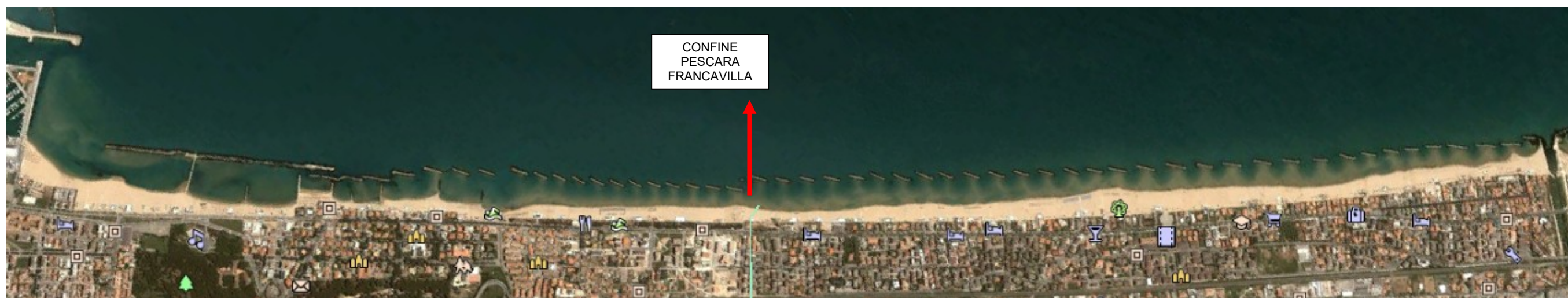
Fig. 3- Anno 2004: Nella parte nord dell'arenile è in corso di realizzazione una longitudinale soffolta.. A tergo di tutto le opere longitudinali è presente una sedimentazione per dinamica diffrattiva più intensa a sud e scema progressivamente verso nord. Il fenomeno è indotto dall'apporto solido dell'Alento.
