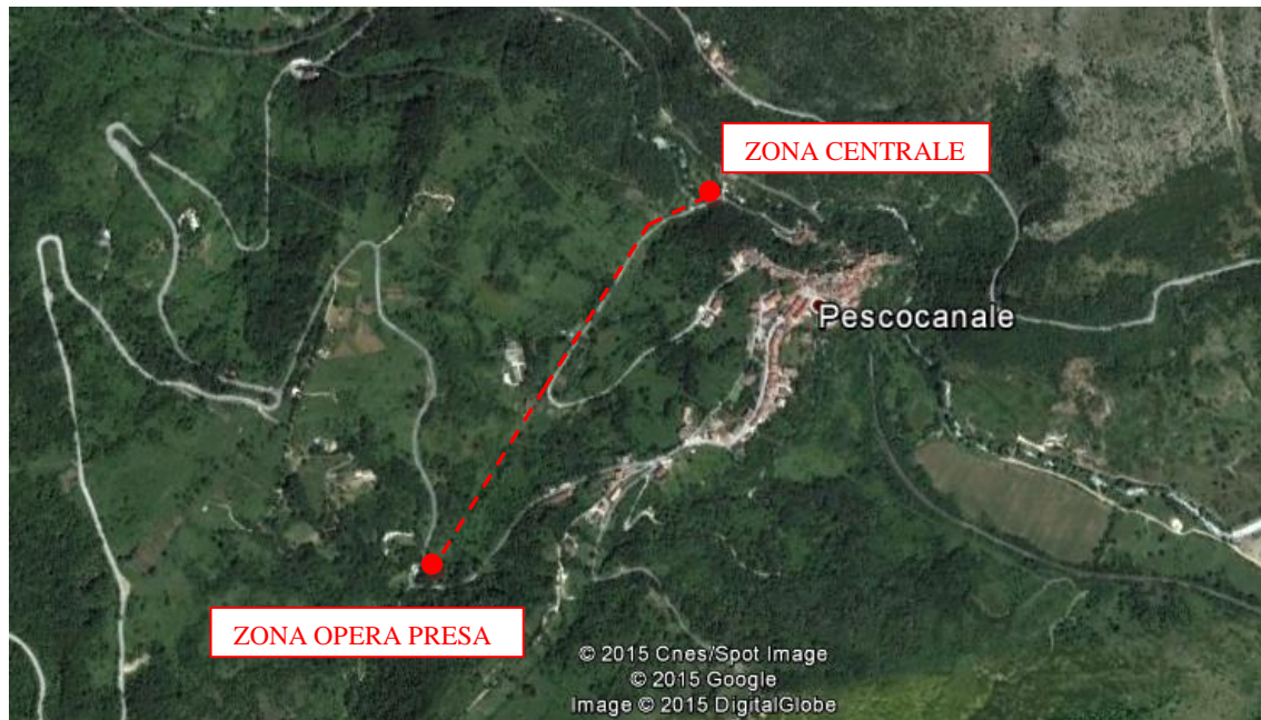
Figura 1 - Estratto Google Earth, zona della presa, centrale e tracciato di massima della condotta
