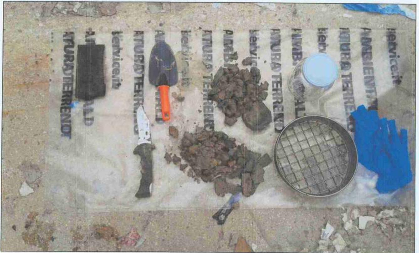
Foto 12 – Campionamento terre, stacciatura ed omogeneizzazione.
