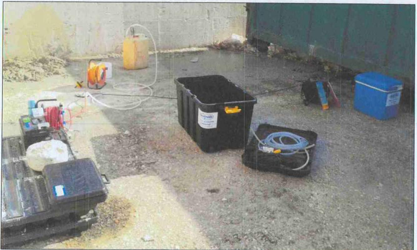
Foto 13 – Spurgo con controllo parametri chimico fisici per campionamento acque.
