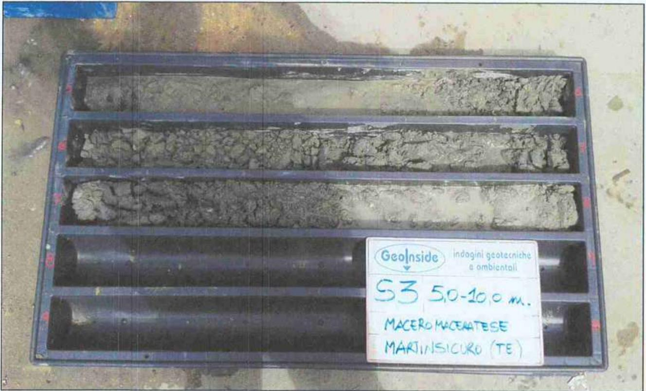
Foto 10 – Cassetta del sondaggio S3 da 5,0 a 10,0 m.
