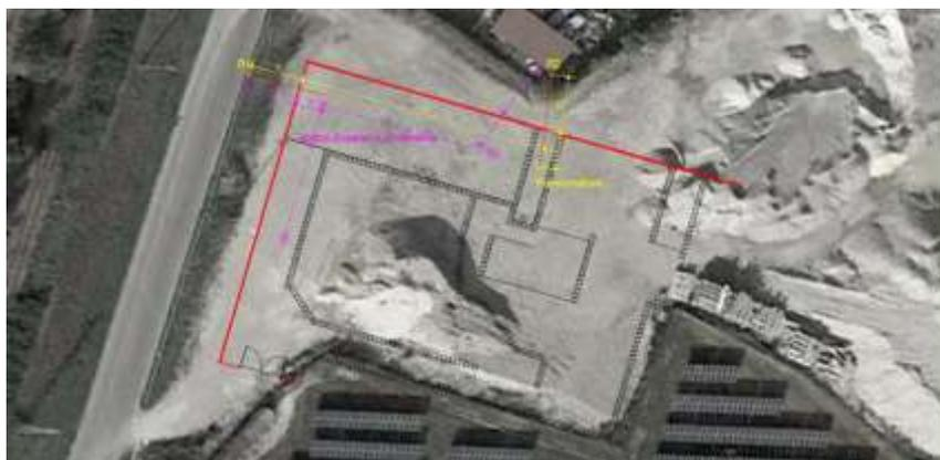
Nella configurazione dei lay out sopra rappresentati si è tenuto conto del posizionamento del trituratore e delle distanze minime dei mezzi in opera dai vari recettori più esposti. Si è inoltre tenuto conto della necessità di inserire delle barriere fono assorbenti come richiesto nella precedente relazione previsionale di impatto acustico.
