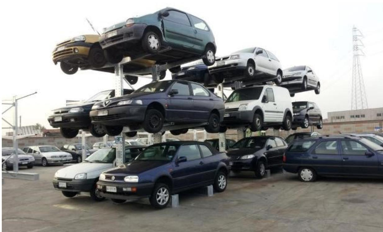
Figura 5.1.3.1: Immagine rappresentativa di stoccaggio su cantilever dei veicoli bonificati ma non trattati.
