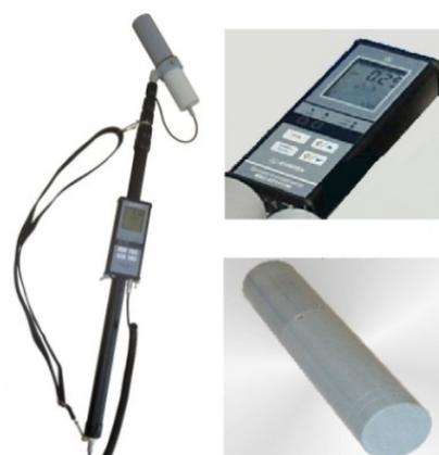
Figura 5.4.1.2.7: Strumento portatile per il controllo radiometrico
