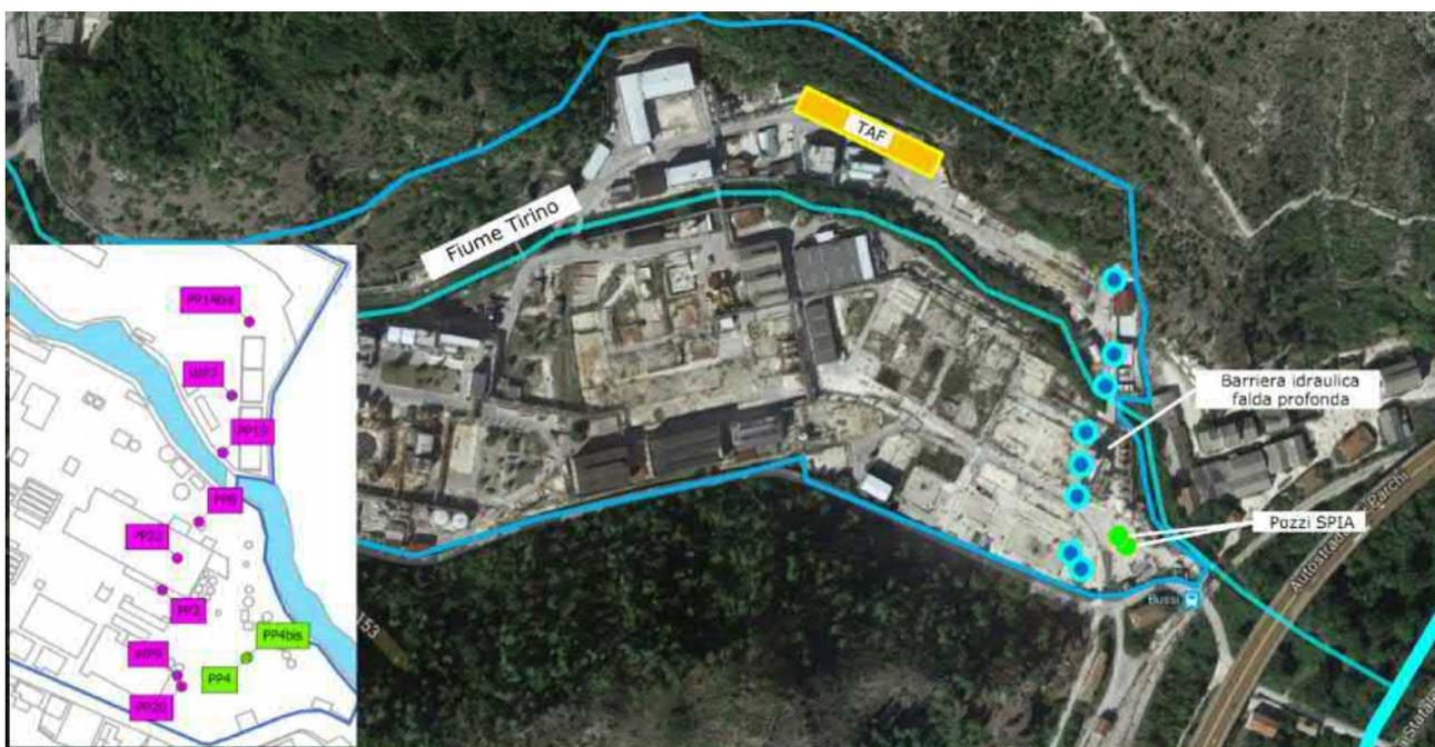
Configurazione barriera idraulica in **FALDA PROFONDA** - Stabilimento SCB
