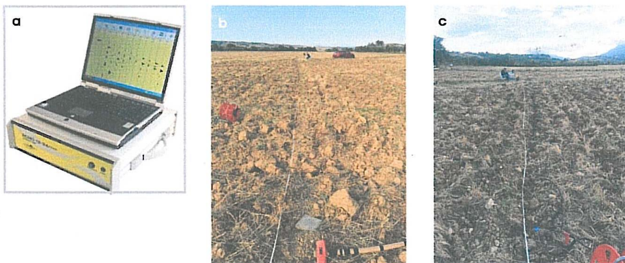
Fig. 3: Strumentazione utilizzata. a) Sismografo ECHO 12-24/2002 a 24 canali; panoramiche dello stendimento da: SW verso NE (b) e da NE verso SW (c); si osserva il sistema di ricezione costituito da uno stendimento di 24 geofoni verticali monocomponente con frequenza propria di 4,5 Hz; (d, b) sistema di energizzazione ad impatto verticale per la generazione di onde P: costituito da una mazza del peso di 8 kg, con interruttore starter, battente verticalmente su di una piastra di battuta in alluminio di dimensioni 20x20x5, in grado di generare onde elastiche ad alta frequenza ricche di energia con forme d'onda ripetibili e direzionali, cioè con la possibilità di ottenere prevalentemente onde di compressione.
