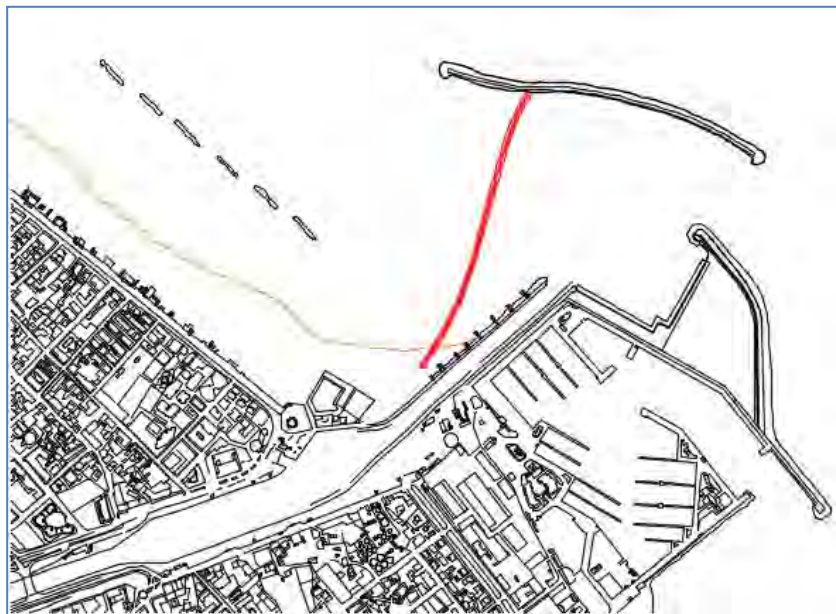
DISPOSIZIONE PLANIMETRICA DELLA BARRIERA SOMMERSA IN FASE DI REALIZZAZIONE AD OPERA DEL PROVVEDITORATO INTERREGIONALE PER IL LAZIO, L'ABRUZZO E LA SARDEGNA
