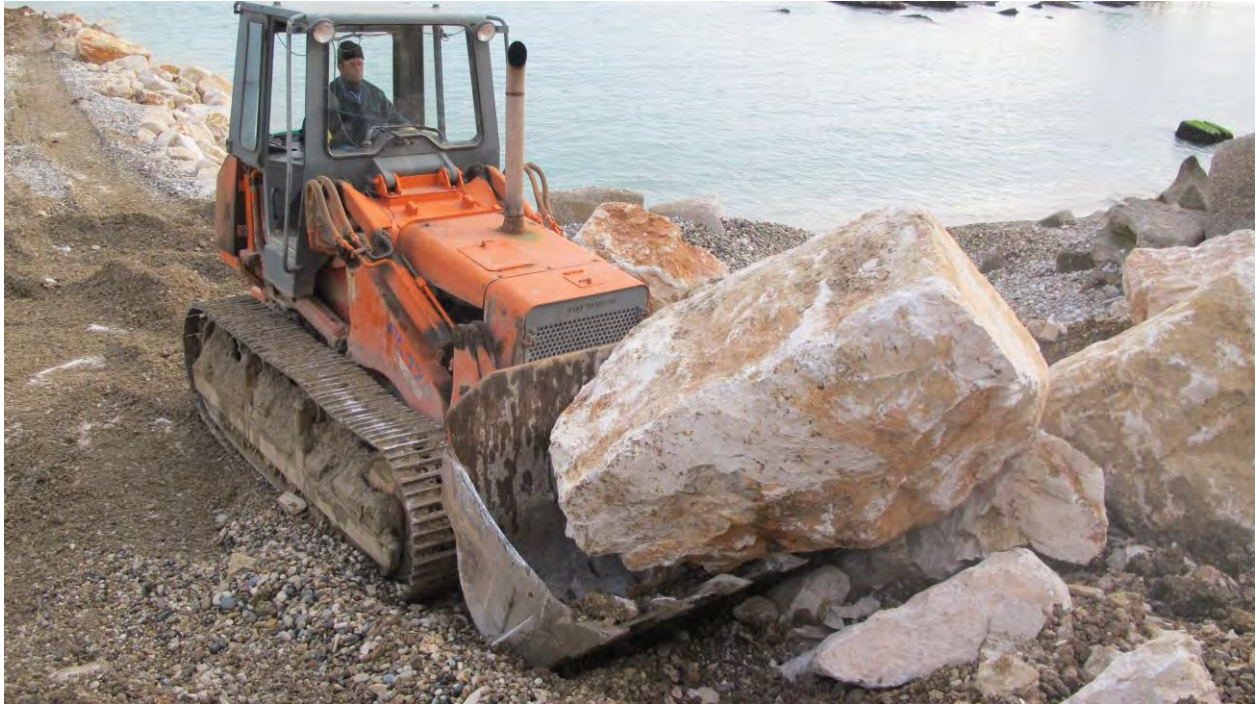
Fig. 4 - Pala meccanica cingolata intenta a movimentare gli scogli.
