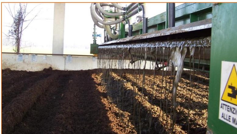
**Sistema di spandimento digestato**
