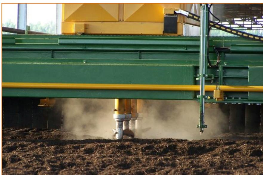
**Sistema di agitazione e insufflazione a coclee**
