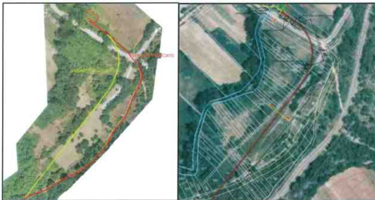
Figura 2: A sinistra, confronto vecchio e nuovo tracciato della condotta. A destra, sovrapposizione su catastale del vecchio (in giallo) e del nuovo tracciato (in rosso) della condotta.
