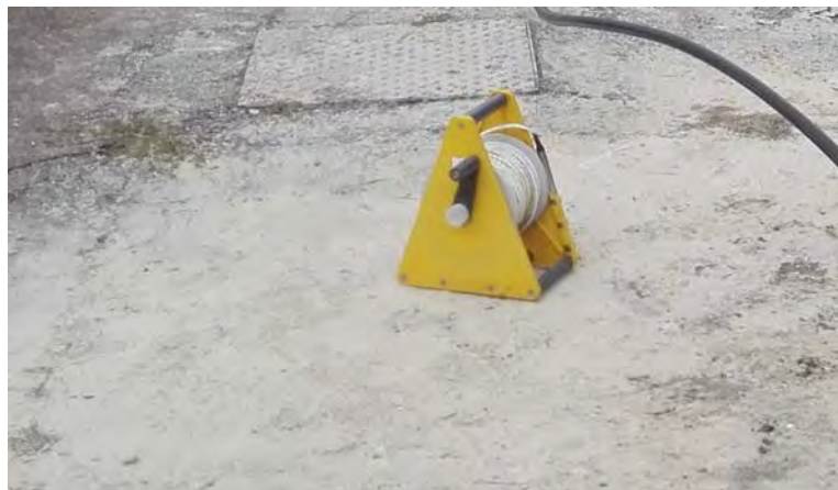
Fig.4 – Misurazione livello piezometrico mediante sonda freaticometrica
