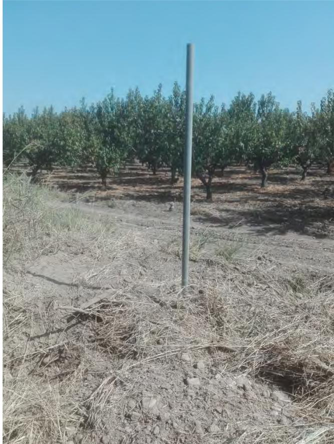
**Fig. n.3** – Piezometro installato.
