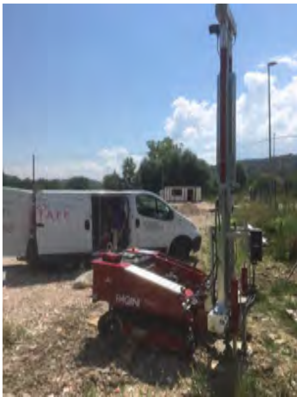
Figura 12: PAGANI 63 – 100 durante l'esecuzione del foro
