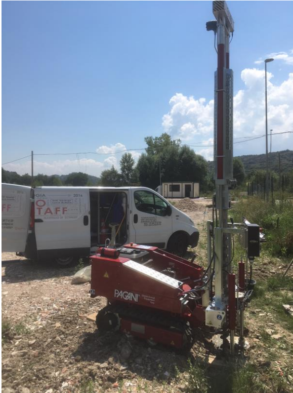
Figura 12: PAGANI 63 – 100 durante l'esecuzione del foro
