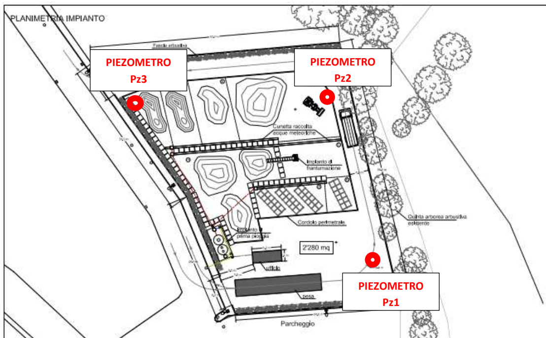
Figura 14: mappa dell'impianto con ubicazione dei piezometri realizzati
