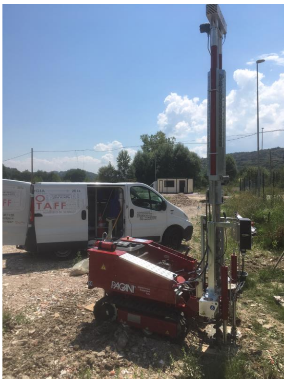
Figura 12: PAGANI 63 – 100 durante l'esecuzione del foro
