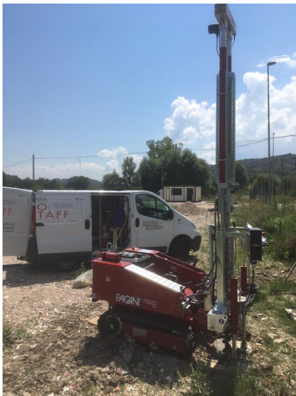
Figura 12: PAGANI 63 – 100 durante l'esecuzione del foro
