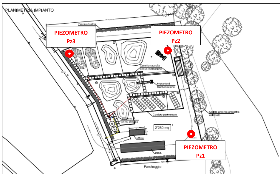
Figura 14: mappa dell'impianto con ubicazione dei piezometri realizzati
