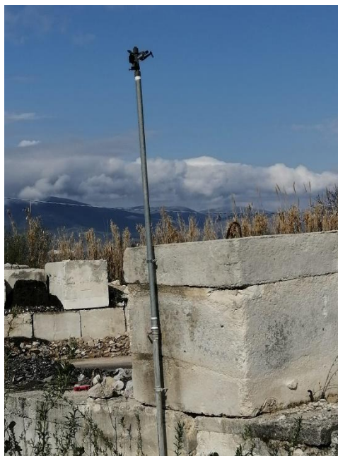
Particolare sistema di bagnatura in prossimità delle MPS
