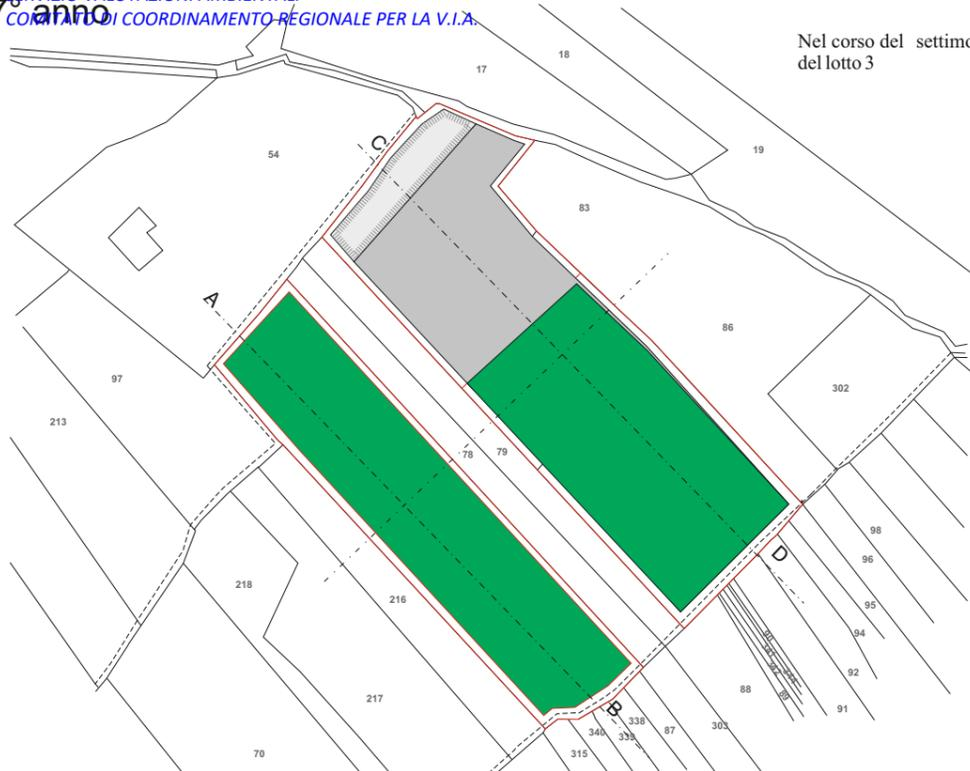
Nel corso dell'ottavo e ultimo anno si completa il residuo ritombamento e si procede alla stesura dello strato di terreno vegetale
