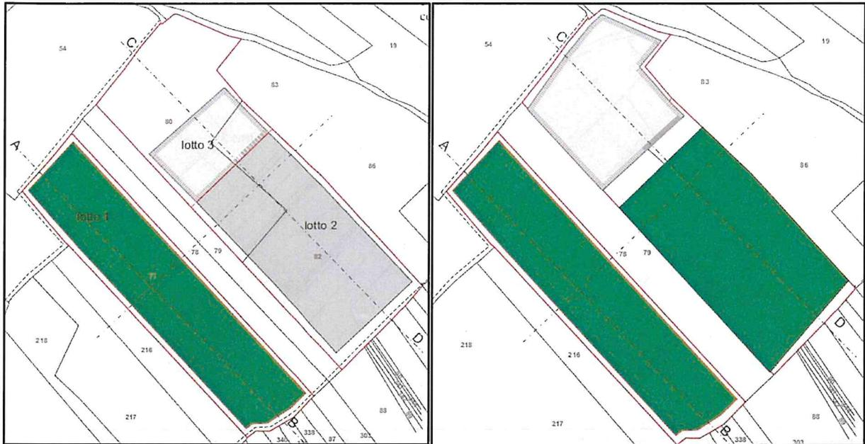
Figura 11: A sinistra, V anno: completamento ritombamento lotto 2 e scavo di parte del lotto 3. A destra, VI anno: stendimento strato vegetale lotto 2 e completamento scavo lotto 3 e avvio del suo ritombamento (da allegato 2 "Coltivazione risanamento cronoprogramma").
