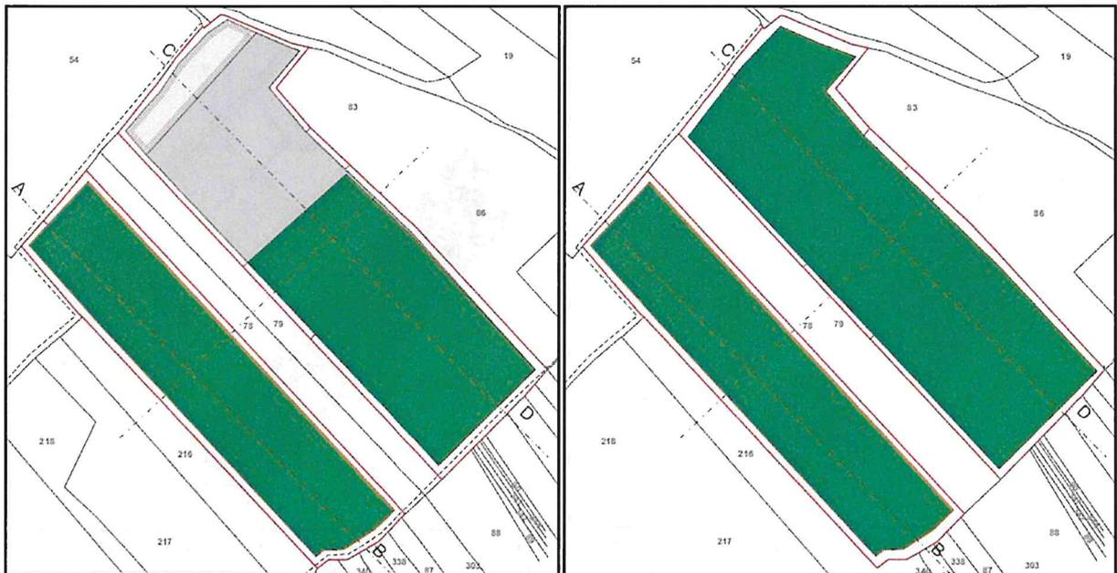
Figura 12: A sinistra, VII anno: prosecuzione ritombamento lotto 3. A destra, VIII anno: completamento ritombamento lotto 3 con stendimento strato vegetale (da allegato 2 "Coltivazione risanamento cronoprogramma").
