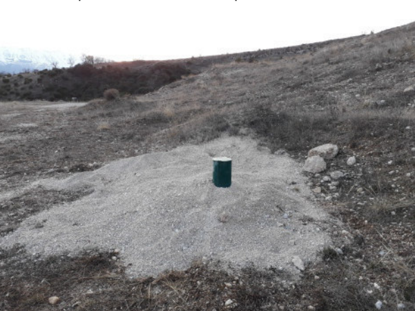
Pozzetto di protezione dei terminali piezometrici
