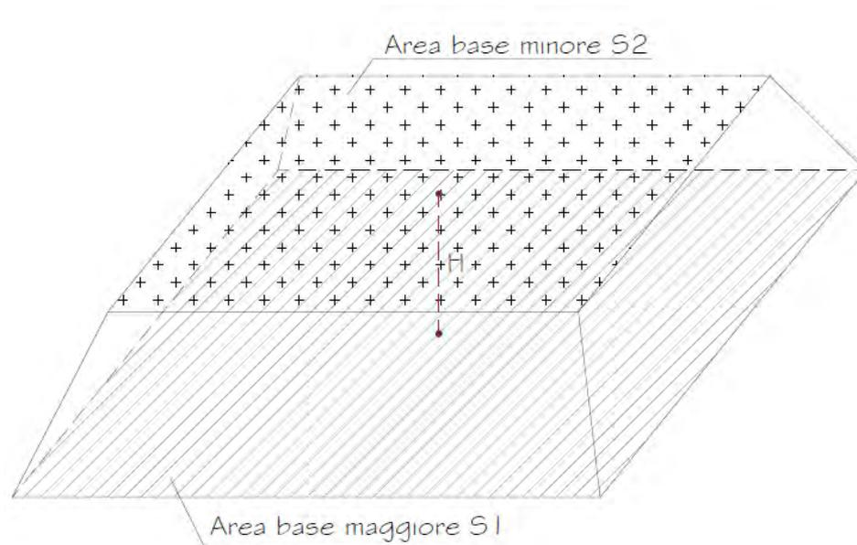
**Figura 2: Cumulo di materiale inerte modellizzato come tronco di piramide**
