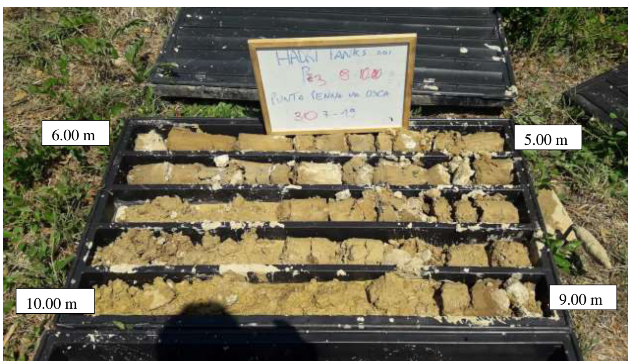
Figura 23: cassetta catalogatrice Pz3 5.00 – 10.00 m.
