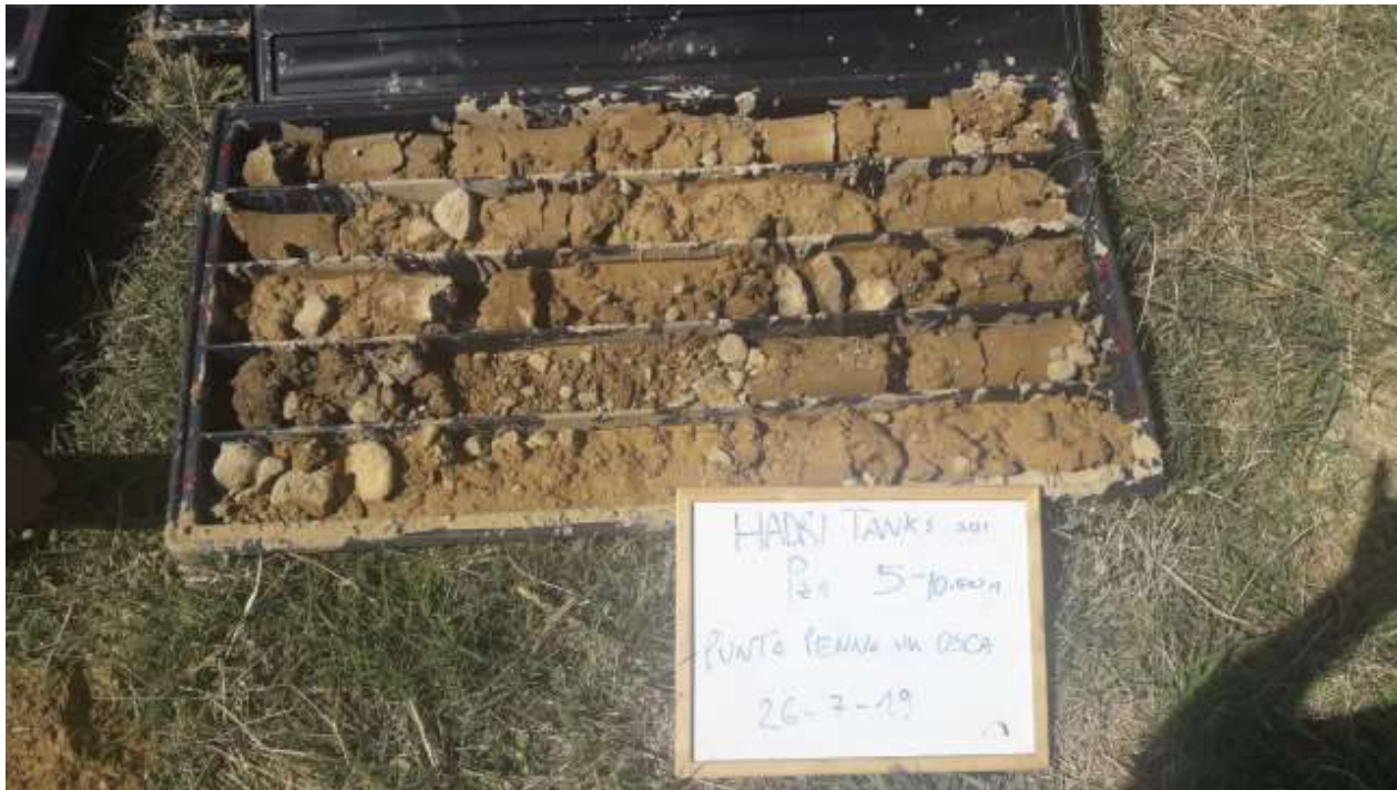
Figura 14: cassetta catalogatrice Pz1 5.00 – 10.00 m.
