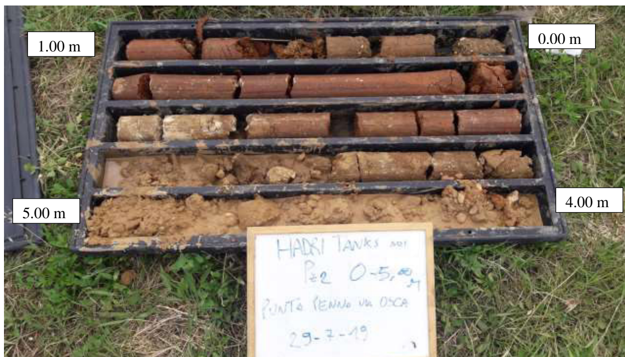
Figura 18: cassetta catalogatrice Pz2 0.00 – 5.00 m.
