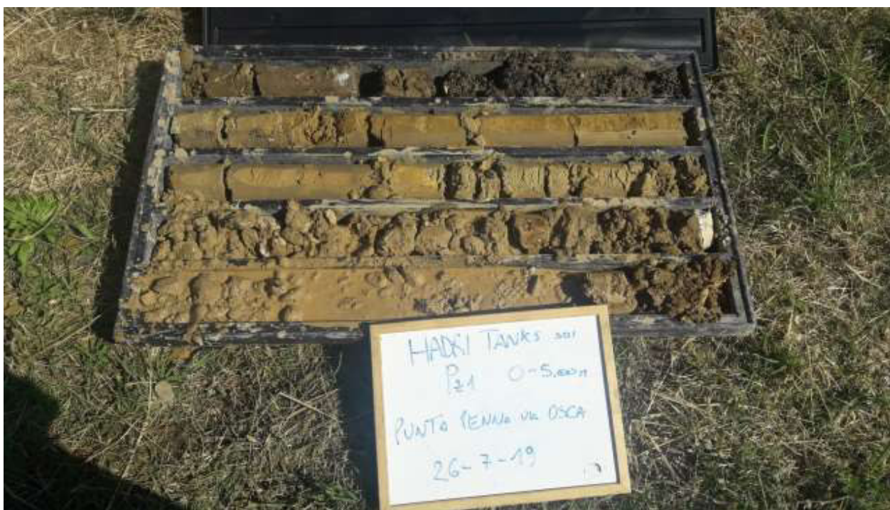
Figura 13: cassetta catalogatrice Pz1 0.00 – 5.00 m.
