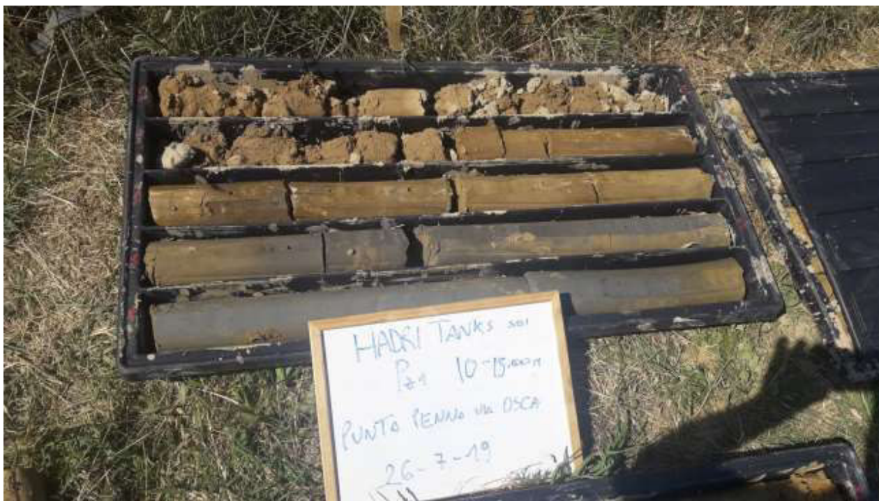
Figura 15: cassetta catalogatrice Pz1 10.00 – 15.00 m.
