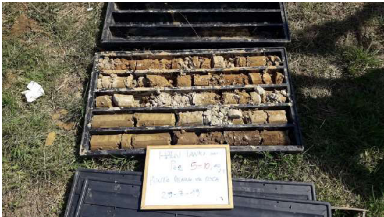
Figura 19: cassetta catalogatrice Pz2 5.00 – 10.00 m.
