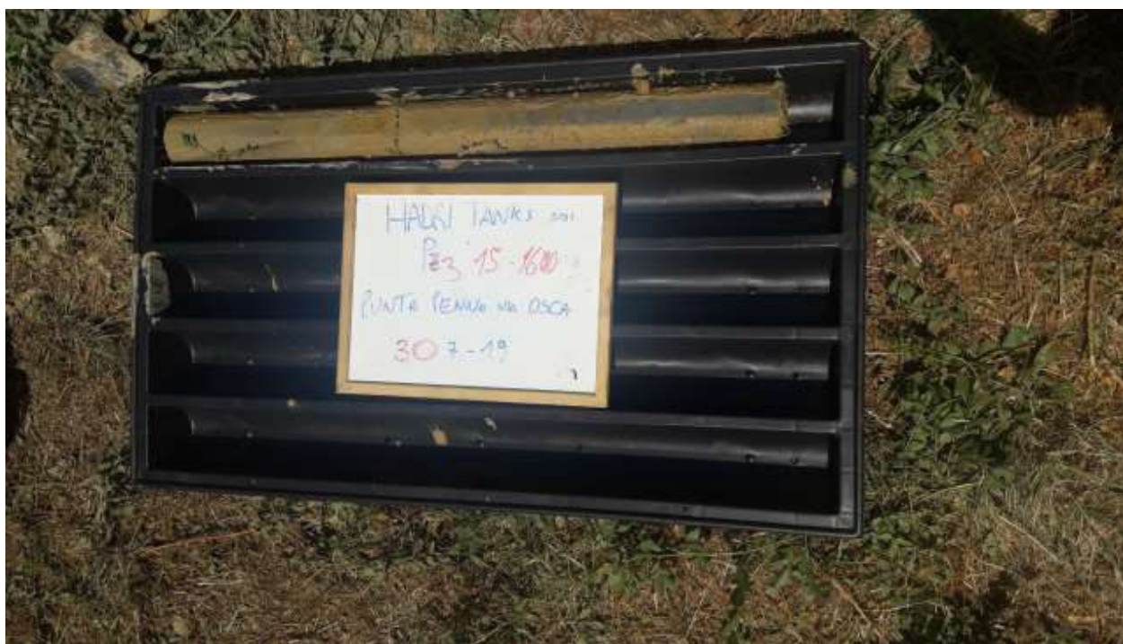
Figura 25: cassetta catalogatrice Pz3 15.00 – 16.00 m.
