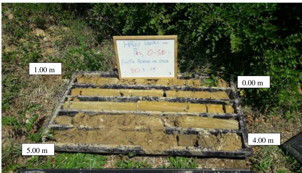
Figura 22: cassetta catalogatrice Pz3 0.00 – 5.00 m.
