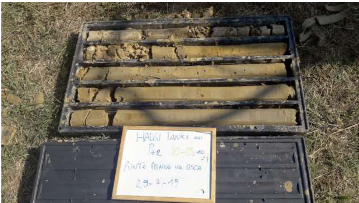
Figura 20: cassetta catalogatrice Pz2 10.00 – 15.00 m.
