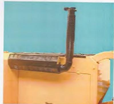
x) Rilasciare la clampa di fissaggio del tubo di scarico e ruotarlo portandolo in posizione verticale. Stringere nuovamente la clampa.
