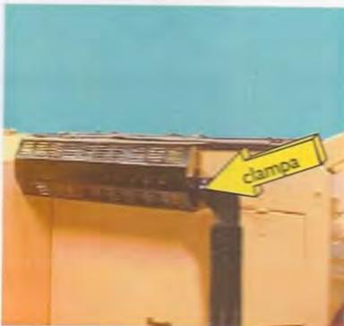
x) Il tubo di scarico viene abbassato per il trasporto.
