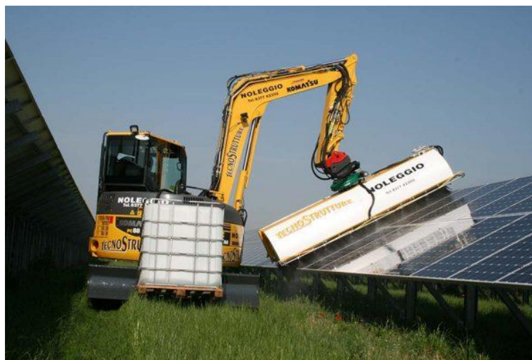
Esempio di sistema di lavaggio moduli fotovoltaici. Fonte delle immagini: sito https://www.tecnostrutture srl.eu/
