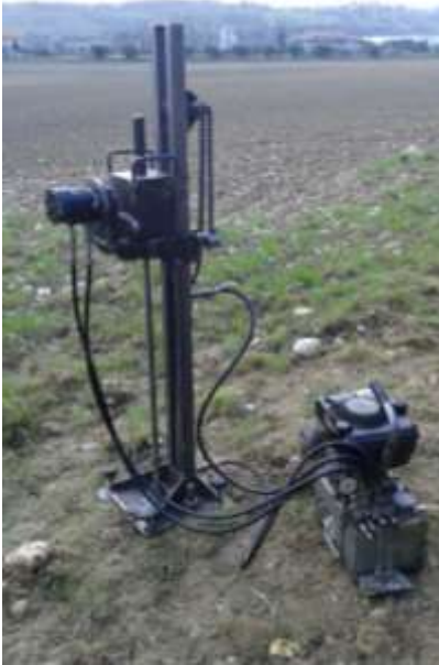
Prova Penetrometrica P1
