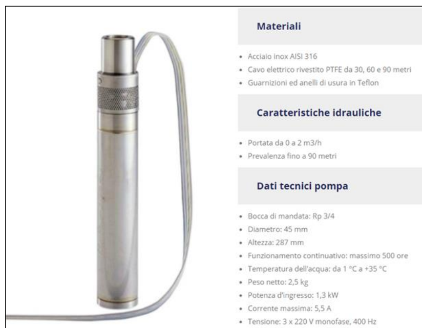
Fig.5- Elettropompa modello GRUNDFOS 3'' con relative caratteristiche tecniche.
