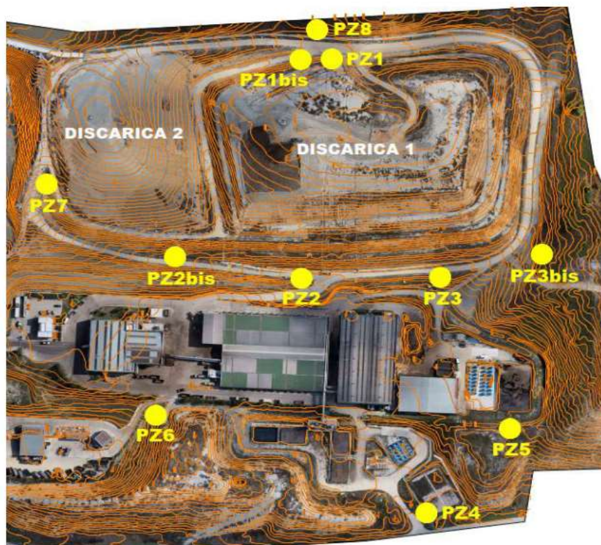
Figura 1. Planimetria Polo Tecnologico Complesso del Consorzio C.I.V.E.T.A. con ubicazione dei piezometri esistenti, con Pz1 e Pz1 bis presenti fino al 7 ottobre 2020.
