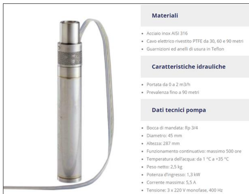
Fig.5- Elettropompa modello GROUNDFOSS 3'' con relative caratteristiche tecniche.
