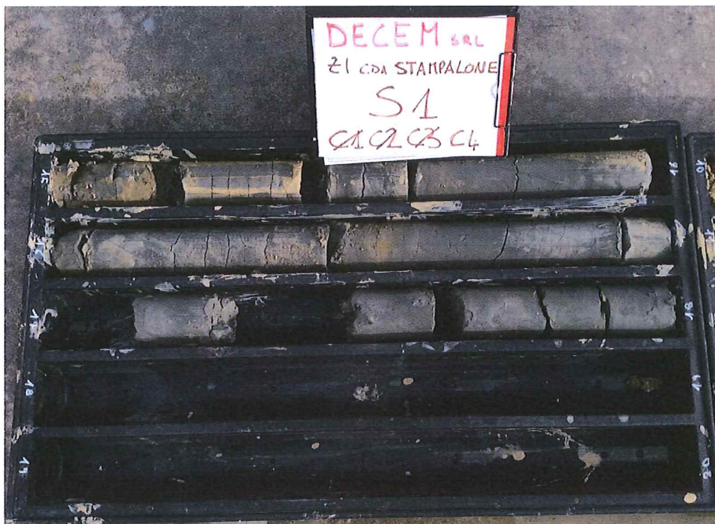
Sondaggio S1 Cassetta C4 : da 15.00 a 18.00 m
