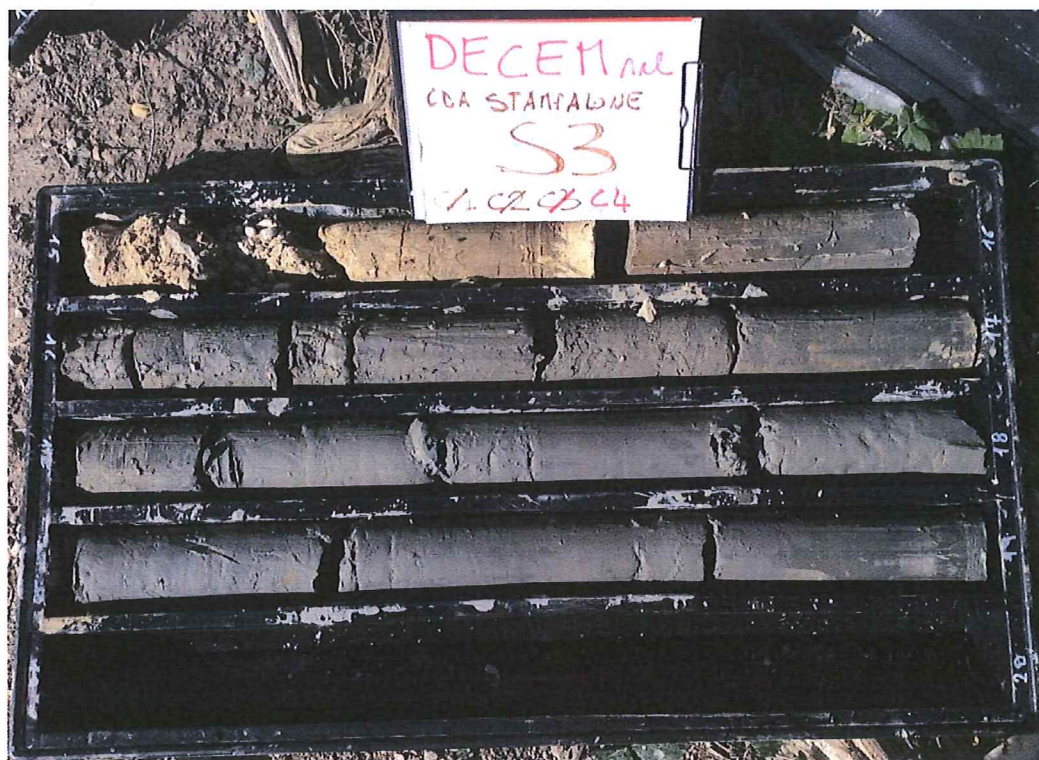
Sondaggio S3 Cassetta C4 : da 15.00 a 19.00 m
