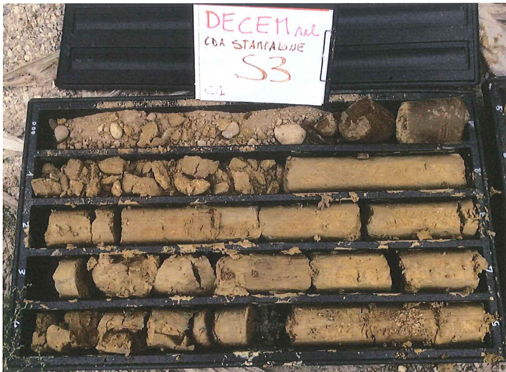
Sondaggio S3 Cassetta C1 : da 0.00 a 5.00 m
