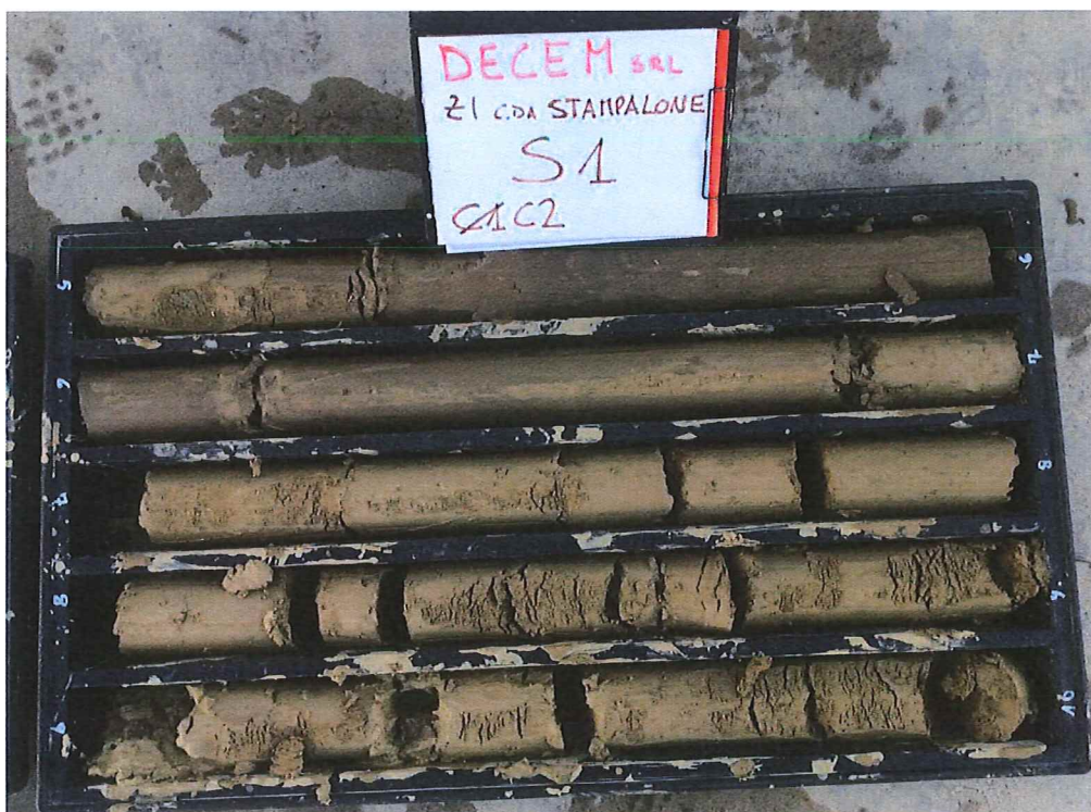
Sondaggio S1 Cassetta C2 : da 5.00 a 10.00 m
