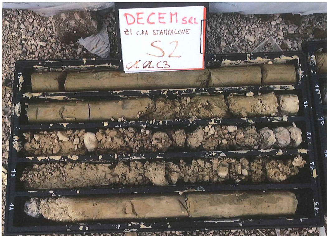
Sondaggio S2 Cassetta C3 : da 10.00 a 15.00 m
