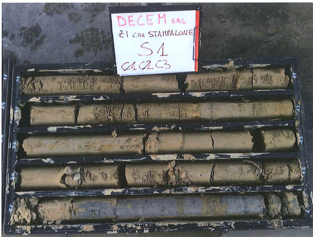
Sondaggio S1 Cassetta C3 : da 10.00 a 15.00 m
