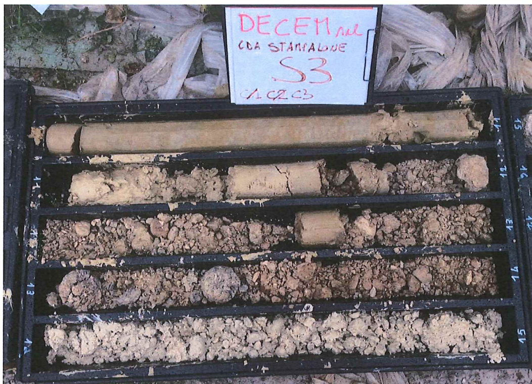
Sondaggio S3 Cassetta C3 : da 10.00 a 15.00 m
