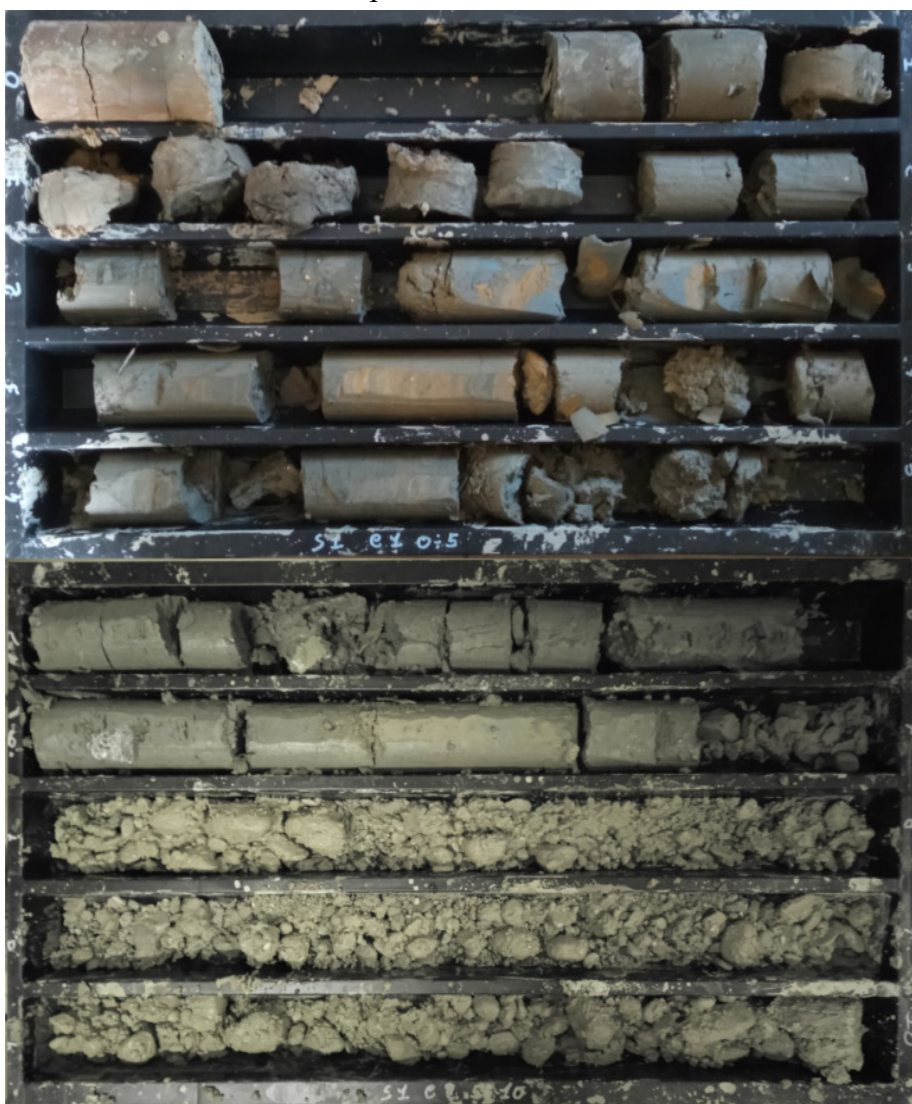
fig. 8: documentazione fotografica reperti di carotaggio perforazione per installazione piezometro
