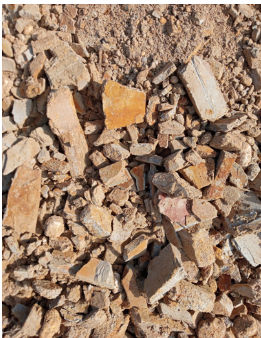
fig. 14: esempio di frammentazione poliedrica della formazione utilizzata per il risanamento ambientale
